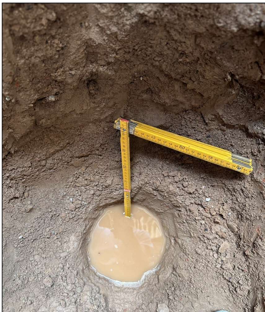
Foto 1: particolare della prova di permeabilità (1,00 m da piano campagna)
