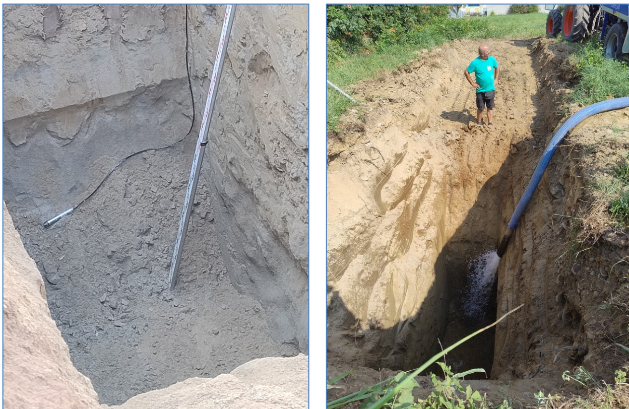
Fig. 7 – Allestimento sensore di livello a fondo scavo in TR1 (sinistra) e fase di saturazione (destra).
